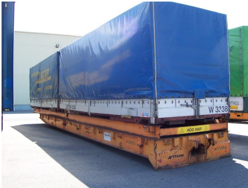
Rysunek 24. Roll-trailer załadowany dwoma nadwoziami wymiennymi Źródło: zdjęcie autora
