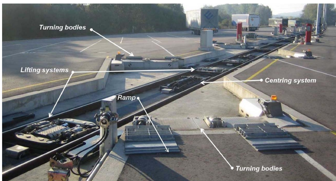
Rysunek 22. Mechanizm przeładunkowy wbudowany w tory ładunkowe terminalu Modalohr Źródło: lohr.fr
