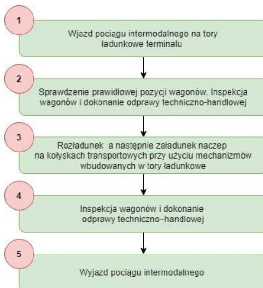
Rysunek 42. Schemat procesu obsługi pociągu intermodalnego na terminalu specjalistycznym Cargobeamer
