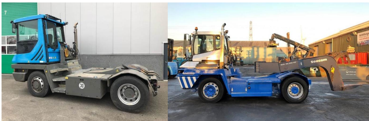
Rysunek 25. Ciągnik terminalowy: do naczep drogowych (po lewej) i roll-trailerów (po prawej) Źródło: tradus.com
