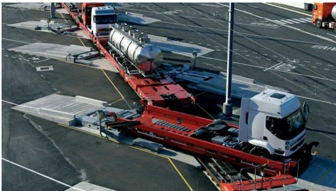
Rysunek 26. Stanowiska przeładunkowe na terminalu specjalistycznym Modalohr Źródło: Poliński J., Podsystemy transportu intermodalnego. Część I, Prace Instytutu Kolejnictwa – Zeszyt 154 (2017)
