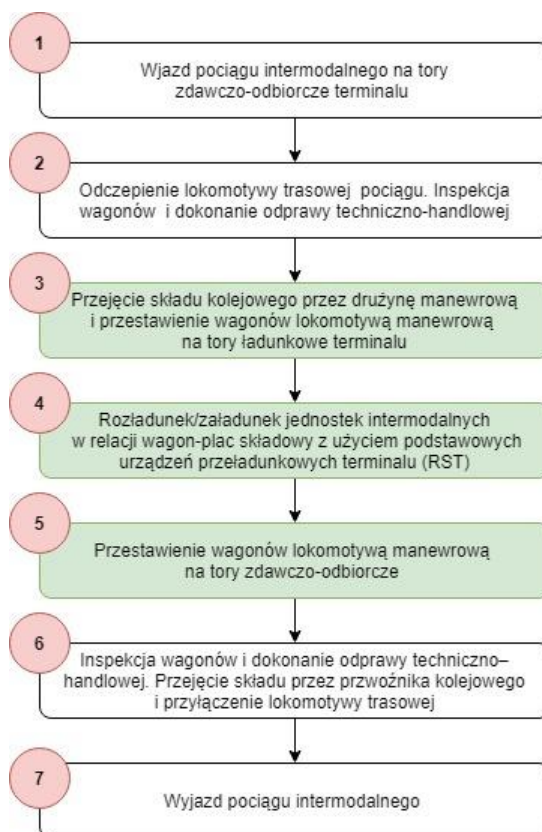
Rysunek 34. Schemat procesu obsługi pociągów kontenerowych na terminalu rzeczny trójmodalnym
