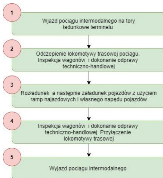
Rysunek 36. Schemat procesu obsługi pociągu intermodalnego na terminalu Ro-La
