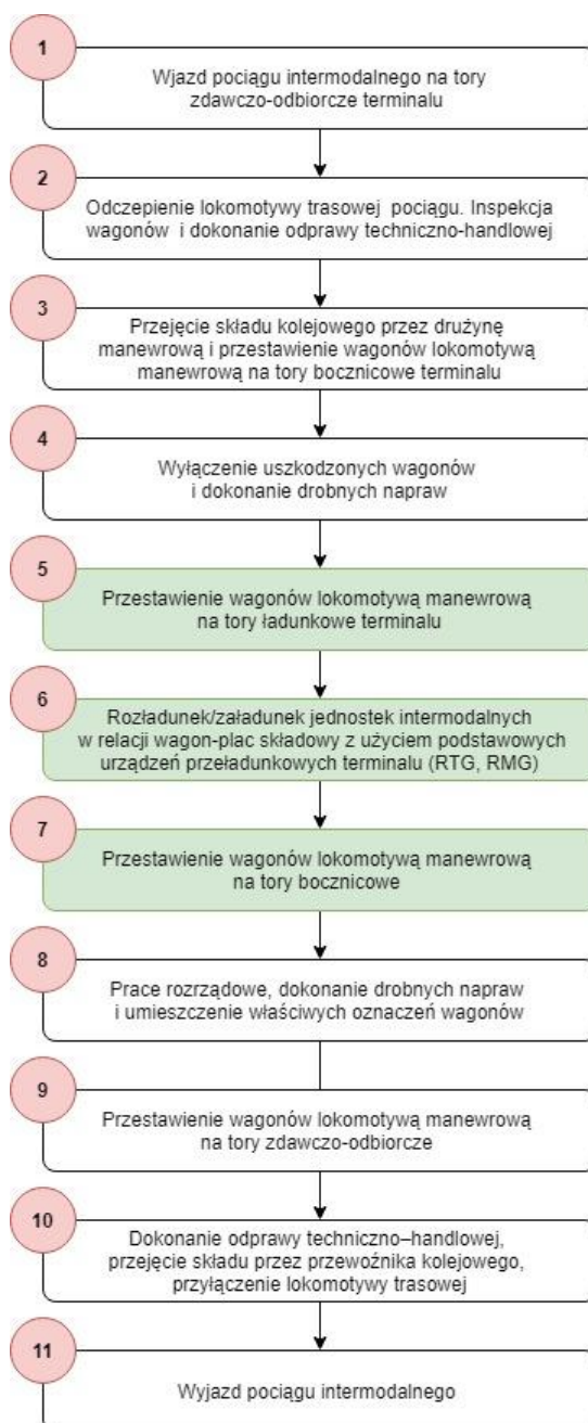
Rysunek 30. Schemat procesu obsługi pociągu intermodalnego na terminalu szynowo-drogowym dużym
