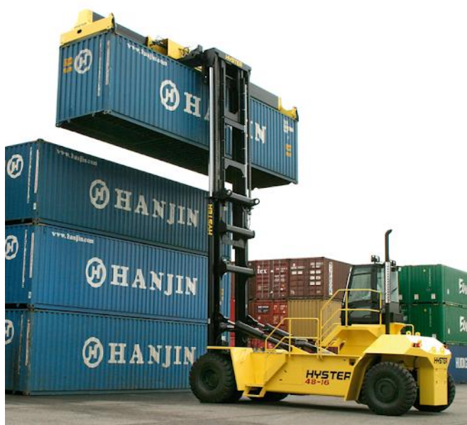
Rysunek 23. Wóz podnośnikowy do przeładunku kontenerów pustych (ECH) Źródło: pesahyster.com.br/product-detail/movimentacao-de-containers-h40-50xm-16ch/
