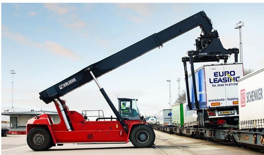
Rysunek 21. Wóz kontenerowy wysięgnikowy reachstacker (RST) Źródło: uniktruck.com
